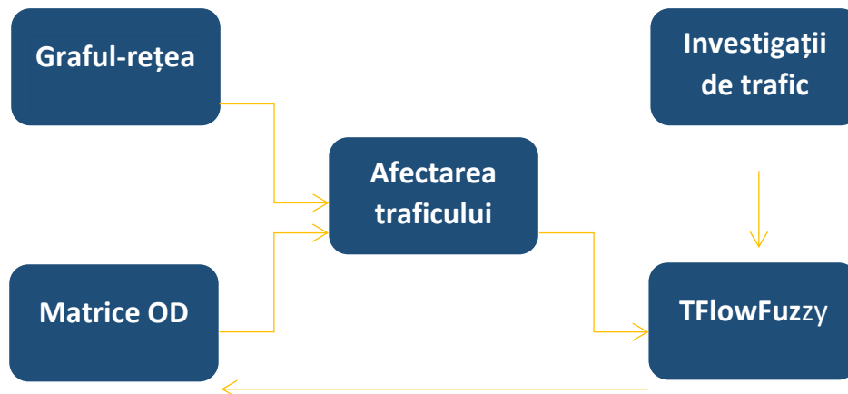
Figura 119.Schema logică a procesului de calibrare utilizat
